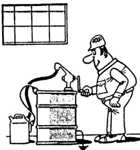
Figura nº 13. Puesta a tierra de las masas metálicas para impedir la acumulación de cargas.
