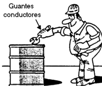
Figura nº 20. El empleo de guantes conductores, unido a las demás protecciones, aseguran una continua descarga hacia tierras.
