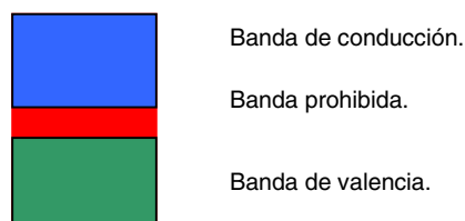
Figura nº 6. Enlace metálico: bandas energéticas.
