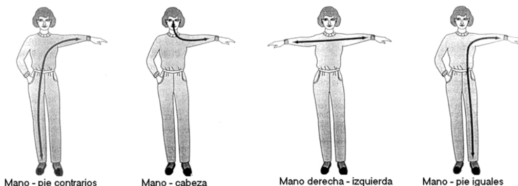
Figura nº 8. Diversas trayectorias de la corriente eléctrica a través del cuerpo humano.
